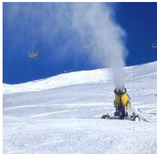
Tehnika razprševanja z nizkim tlakom zraka
